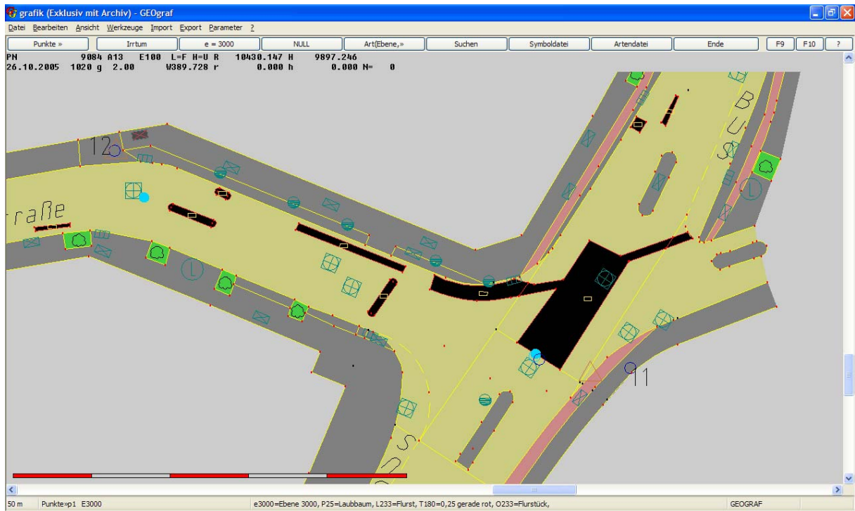
Abb. 9.3.-1: Grafik der aufgemessenen Flickschäden (Kreuzung Melchersstraße – Wienburgstraße)
