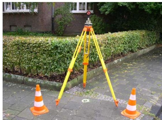
Abb. 2.2.2.-2: Polygonpkt. Nr.19 mit Aufbau u. Sicherung
